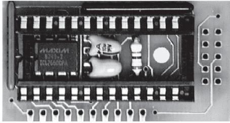
Abmessungen: 46,5 mm x 25 mm x 9 mm
